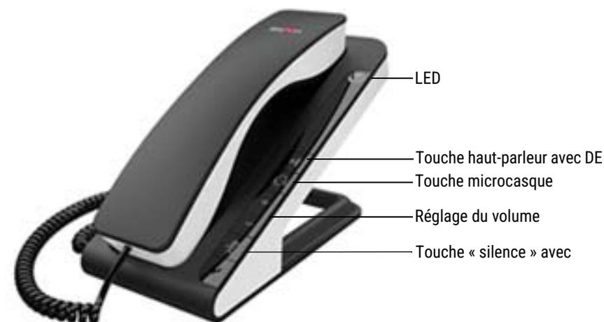
Les touches « plus » et « moins » permettent de régler le volume. Le réglage du volume agit sur le dispositif de sortie (microcasque, écouteur et haut-parleur) utilisé à ce moment-là pour restituer la voix. La touche « silence » connecte ou déconnecte le microphone utilisé à ce moment-là. La touche « microcasque » active ou désactive le mode microcasque. La touche « haut-parleur » active le haut-parleur du dispositif.
